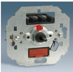
**75318 -39** Электронный регулятор напряжения с подсветкой (выключатель/переключатель), от **40 до 500 Вт** 230 В-.
