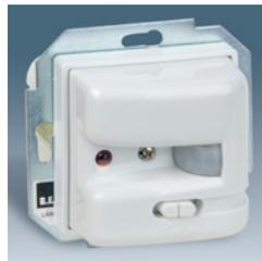
**82340 -30** Выключатель-детектор движения инфракрасный, включение от движения или по звуку для любого типа ламп накаливания, галогенных прямых или низкого напряжения с электромагнитным (не электронным) трансформатором от 40 (80 Вт при параллельной схеме) до 300 Вт, с задержкой выключения от 4 секунд до 10 минут.
