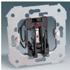
**26526 -39** Выключатель-переключатель (проходной) под карточку с 1 микровыключателем 6 А 250 В- (2 А индуктивные нагрузки), со световым индикатором. 10
