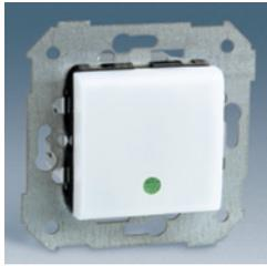
**75809 -39** Аварийный датчик электропитания. Лампа автономного датчика загорается автоматически в случае прекращения подачи электроэнергии, излучая свет в 5 люкс в течение одного часа. (Время первоначальной зарядки 24 часа). Имеет светодиод – индикатор подключения к сети.
