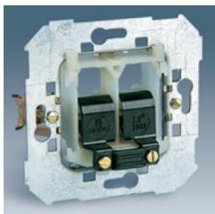
**75801 -39** Кабельный вход, с 4 зажимами-выводами, сдвоенными попарно, для провода сечением до 2,5 мм<sup>2</sup>, 380 В-.
